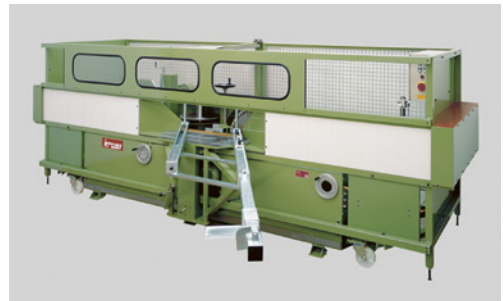
1 Bei Maschinen ab Baujahr 1997 verhindert eine Umwehrung den Zutritt.
