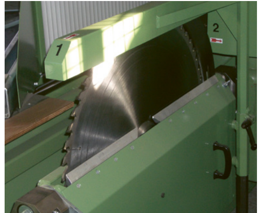
2 Abkürzsägeblatt mit Schutzhaube und oben abgeschrägter Verkleidung.
