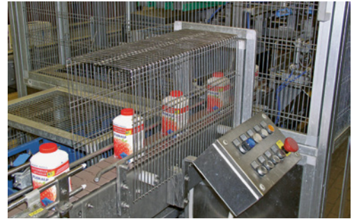
1 Tunnel verhindert Zugriff. (Entfernung zur Gefahrenstelle \geq 850 mm)
