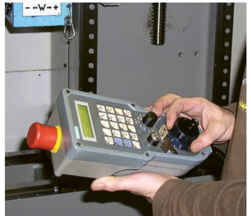
6 Elektronisches Handrad mit Not-Halt-Taste
