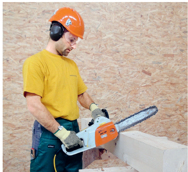
1 Indossare dispositivi di protezione adeguati al lavoro
