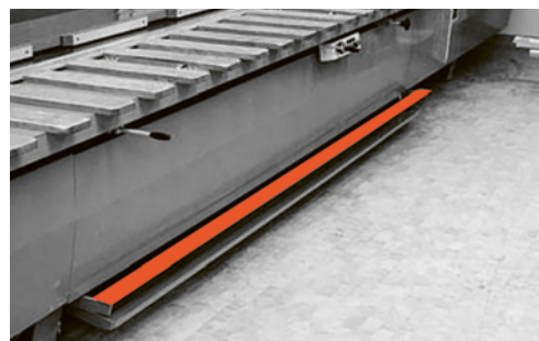
1 La copertura della barra di azionamento del comando a pedale impedisce l'avviamento accidentale della lama circolare.
