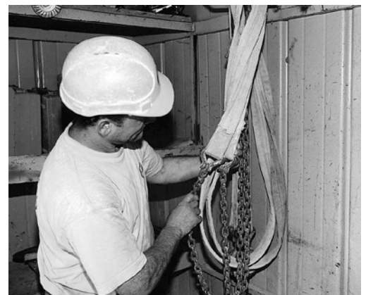
6 Kontrolle der Anschlagmittel.
