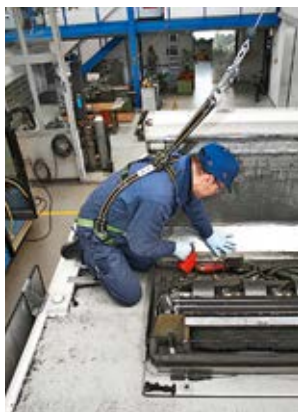
3 Messa in sicurezza con DPI anticaduta
