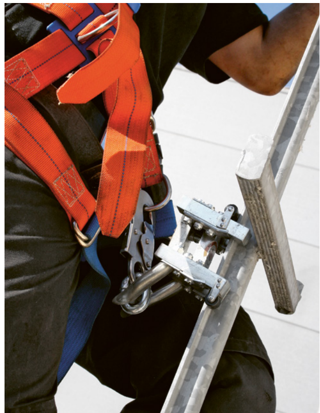
8 (Detail zu Bild 7): Läufer des Steigschutzsystems.
