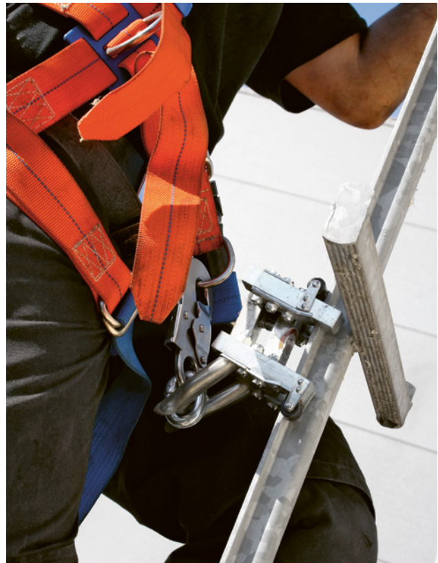
8 (Detail zu Bild 7): Läufer des Steigschutzsystems.
