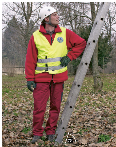
2 La corretta inclinazione si misura con la prova del gomito. Se l'angolo di appoggio è di circa 75°, la scala è posizionata in modo sicuro e non ci sono problemi.
