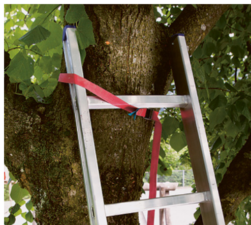
4 Testa della scala fissata all'albero
