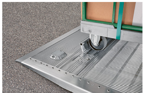
4 Hayon élévateur équipé d'un arrêtoir
