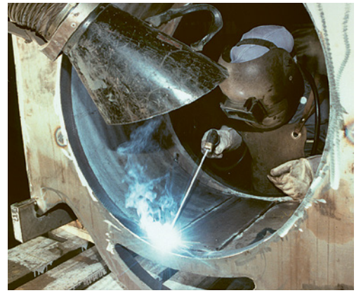
4 Trichterförmige, flexible Einrichtung zum Erfassen und Absaugen von Schweissrauch.
