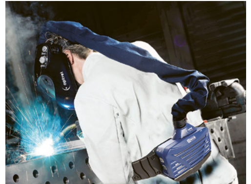
5 Beim Lichtbogenhandschweißen oder Plasmaschneiden von legierten Werkstücken muss ein Gebläsefiltergerät SN EN 12941 der Klasse TH2 oder TH3 mit Schweisserhelm und Partikel- oder Kombinationsfilter benützt werden.
