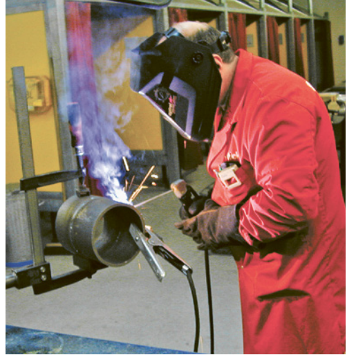
1 Vor Beginn der Arbeiten muss sich der Schweißer davon überzeugen, dass die Schweisstromrückleitung einwandfrei angeschlossen ist.
