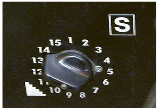
2 Kennzeichnung [S] für Schweissstromquellen bei Arbeiten unter erhöhter elektrischer Gefährdung.
