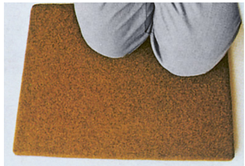
3 Der Lichtbogenschweißer schützt sich mit einer isolierenden Unterlage und Sicherheitsschuhen vor Stromschlägen.
