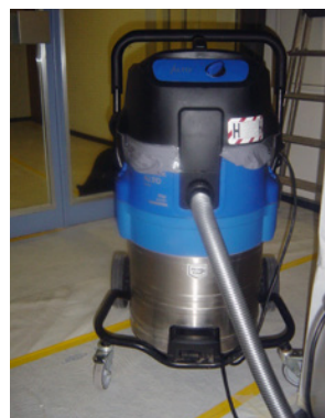
2 Industriestaubsauger mit Filter für Staubklasse H (Asbest)
