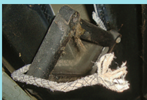
Corde di amianto
