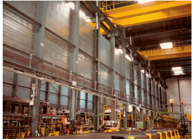
31 Blende zur akustischen Entkoppelung einzelner lärmintensiver Arbeitsbereiche.
