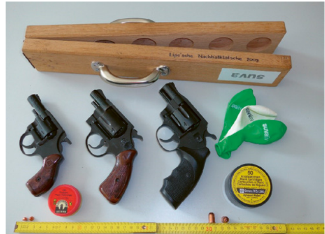
8 Schallquellen zur Impulsanregung
