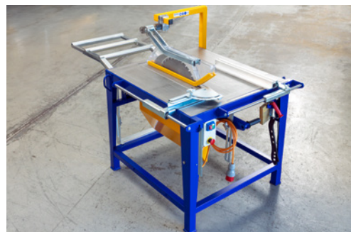
2 La lama della sega deve essere schermata sotto il piano di lavoro in modo che non si possa entrare in contatto con la sua dentatura.
