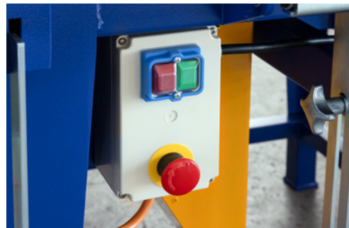
1 Unità di comando con dispositivo di arresto di emergenza e interruttore di avviamento incassato per evitare l'avviamento accidentale della macchina.
