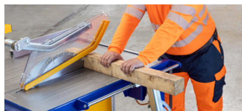
3 La cuffia Suva B90 si abbassa automaticamente alla sua posizione di sicurezza così da offrire una protezione elevata. L'utilizzo di una cuffia di protezione ad abbassamento automatico è vivamente consigliato.
