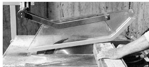
3 La cuffia Suva B90 si abbassa automaticamente così da offrire un'elevata protezione. L'uso di una cuffia di protezione automatica è urgentemente consigliato.
