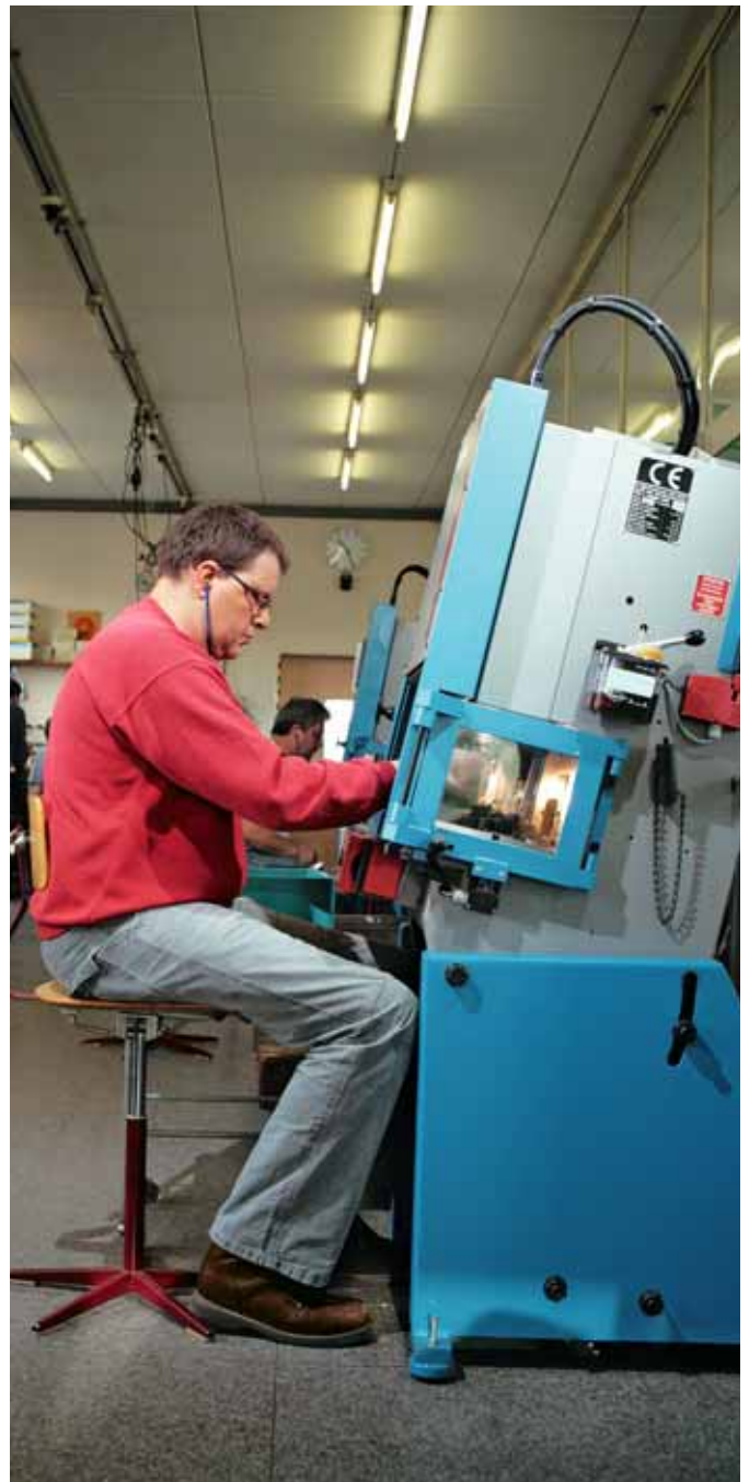
01 // Il dispositivo di protezione sulla nuova pressa – la schermatura mobile con azionamento a pedale – garantisce un lavoro sicuro.
