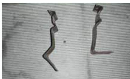
03 // I paraneve si sono piegati a causa del peso eccessivo e si sono staccati. // Fotos: Suva
