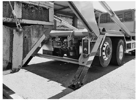
8 Beim Kippen und Entleeren der Behälter wirken grosse Kräfte auf das Fahrzeug. Deshalb sind die Stützen grundsätzlich herunterzufahren.
