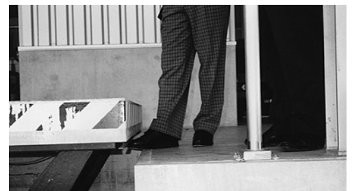
8 Kontaktleisten verhindern zum Beispiel, dass ein Fuss eingeklemmt wird.
