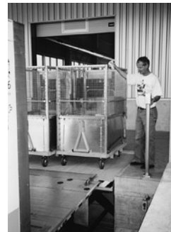
3 Dieser Bediener hat für das Heben und Absenken der Hebebühne eine gute Sicht.
