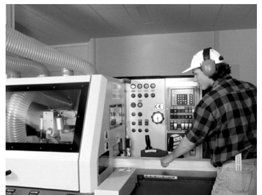
6 Avanzamento meccanico (MEC): in questo caso il pezzo o l'utensile vengono tenuti e controllati meccanicamente durante la lavorazione (ad es. piallatrici quadrilaterali, squadratrici-tenonatrici doppie, centri di lavorazione CNC).
