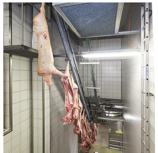
Image 7: rail tubulaire séparé des voies de circulation
