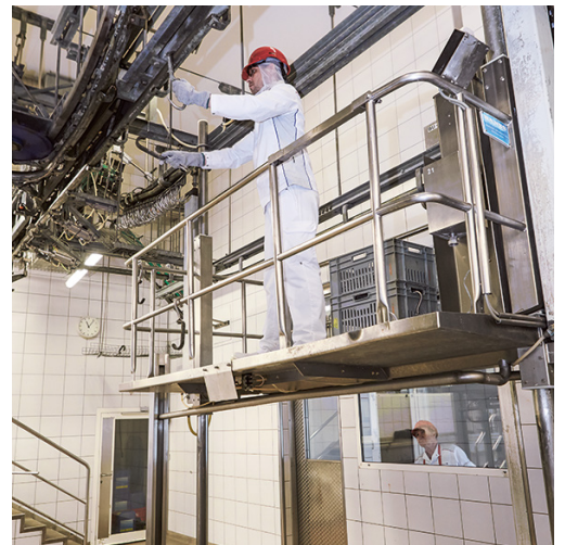
Image 6: dispositif de protection contre les chutes adapté
