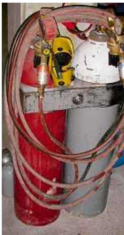
Bild 7: Acetylen und Sauerstoff: die Bestandteile des Autogenschweissens.
