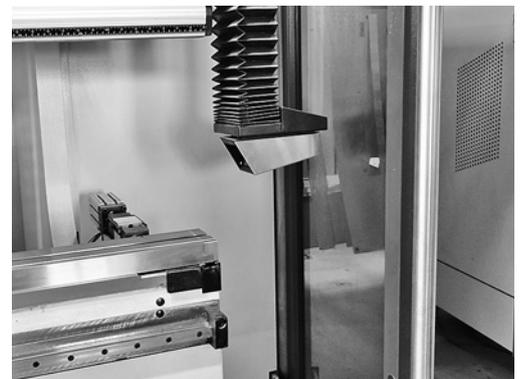
4 Mitfahrende optische Schutzvorrichtung und seitliche Schutztüre. Der Aufenthalt zwischen der Schutztüre und dem Werkzeug darf nicht möglich sein.
