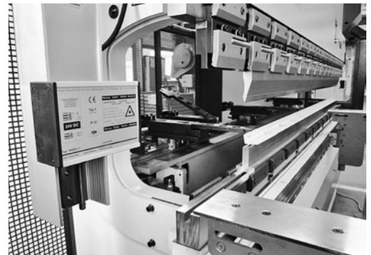
3 Mit der Oberwange mitfahrende optische Schutzvorrichtung.
