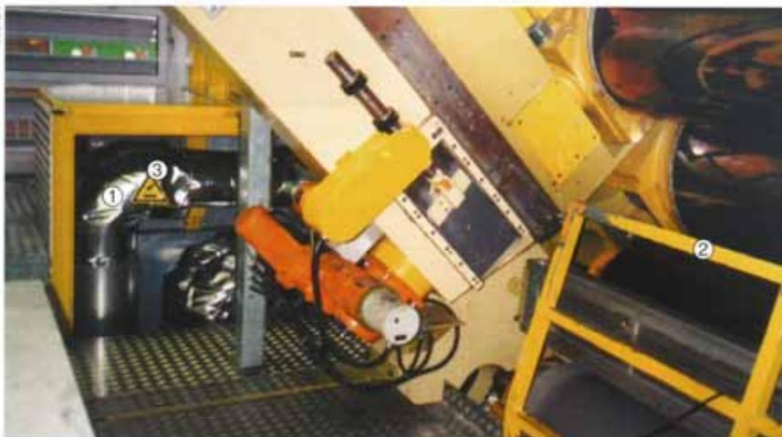
Figure 42: Calandre dans une entreprise de transformation des matières plastiques. Les tuyaux de chauffage (1) des cylindres de calandre sont isolés. L'installation est pourvue d'un garde-corps (2) prévenant toute chute sur les cylindres chauffés. En outre, le panneau «Attention, pièces chaudes» (3) met en garde contre le danger que présentent les surfaces chaudes.
