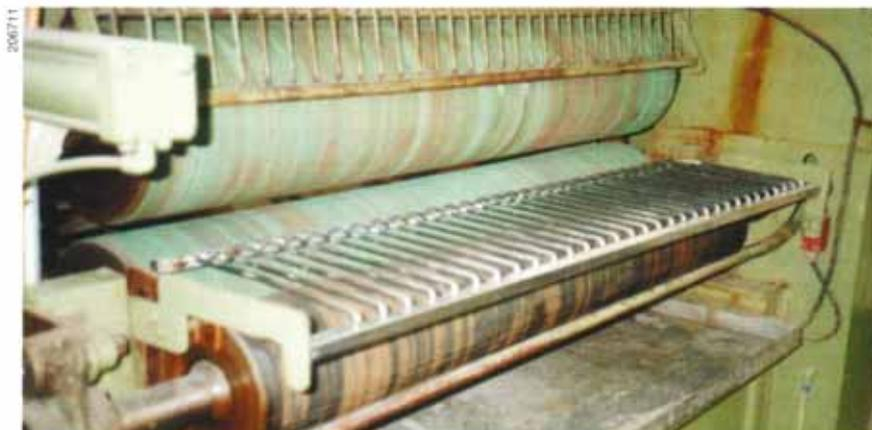
Figure 29: Encolleuse à quatre cylindres dans une entreprise de traitement du bois.
