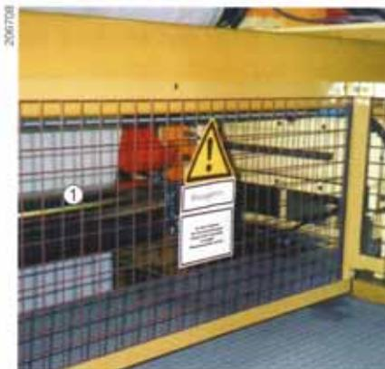
Figure 23: Poste de déroulage d'une installation d'application de revêtements (entreprise de traitement des matières plastiques). La zone d'entraînement et d'écrasement (1) des cylindres dérouleurs est recouverte.
