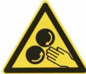
Figure 45: Mise en garde contre les zones d'entraînement, réf. 1729/67.
