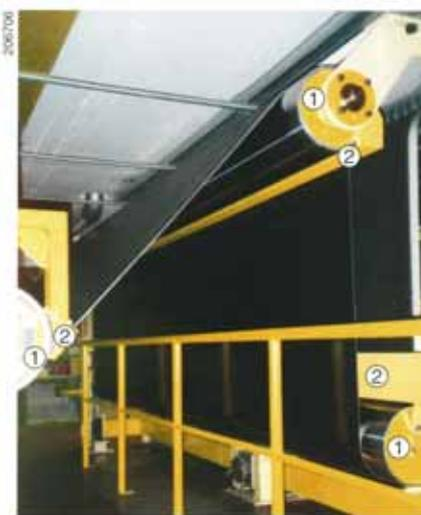
Figure 21: Installation d'application de revêtements (entreprise de traitement des mat. plastiques). Les zones d'engagement de la bande sur les cylindres de déviation (1) sont protégées par des barres de protection (2).
