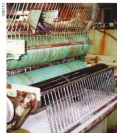
Figure 30: Encolleuse à quatre cylindres dans une entreprise de traitement du bois.
