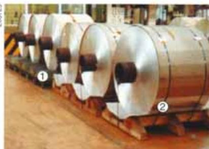
Figure 41: Cylindres de bandes d'aluminium dans une société de confection de feuilles d'aluminium.
