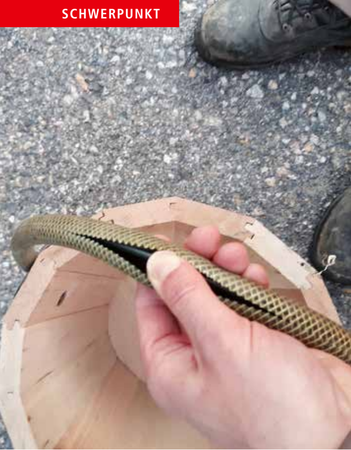
Umgesetzter Mitarbeitervorschlag: Eine Kunststoffhülle verringert die Wärmeleitung vom heissen Asphalt.
