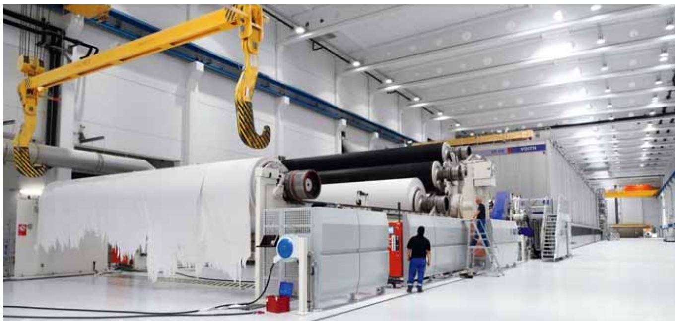
01 // Produzione ad alta velocità: la carta scorre tra i rulli a 100 km all'ora.
