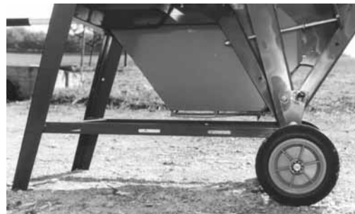
Fig. 3: la lame de scie doit être encaissée sous le chariot porte-grume pivotant de telle sorte que ses dents soient hors d'atteinte (encaissement inférieur: min. 15 cm, largeur: max. 10 cm).
