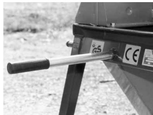
Fig. 5: des poignées facilitent le transport de la machine.
