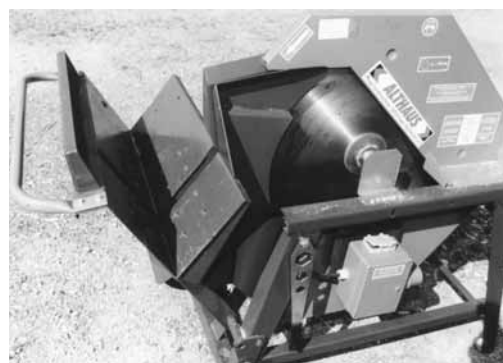
Fig. 3: en position initiale, le chariot porte-grume pivotant doit entièrement recouvrir la lame de scie.
