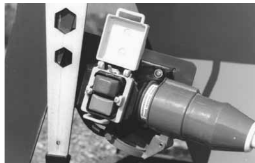
Fig.1: un interrupteur encastré ou positionné en contrebas permet de prévenir une mise en service involontaire de la scie circulaire.
