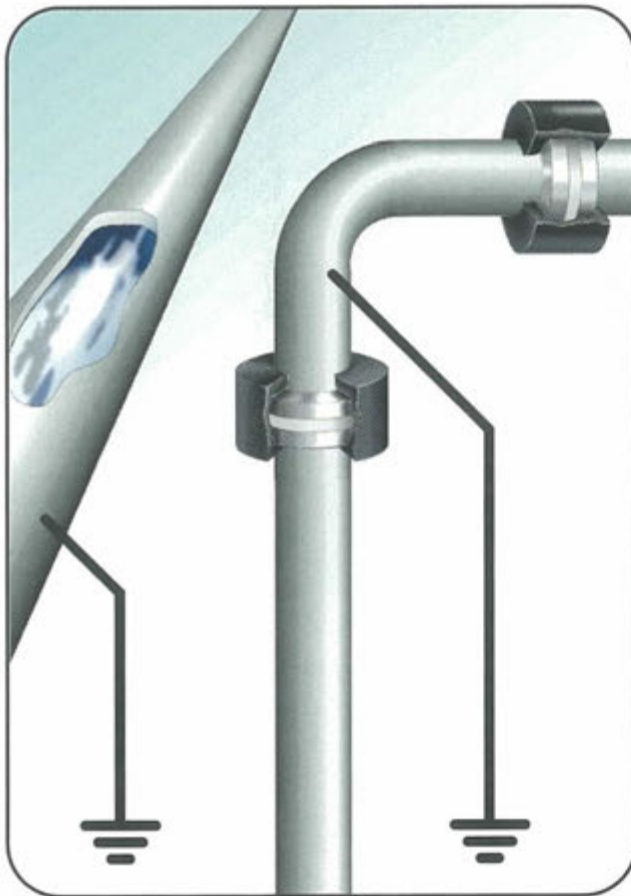
Abb. 21: Beispiele für das Vermeiden von Funkenentladungen durch Erden aller leitfähigen Teile und Produkte (vgl. Abb. 20)
