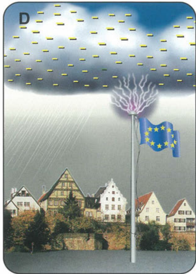
Abb. 23: Beispiele von Büschelentladungen in der Praxis - A: durch aufgeladenen Schüttgutbehälter B: durch aufgeladene, isolierende Flüssigkeit C: durch aufgeladene Staubwolke D: durch aufgeladene Gewitterwolke
