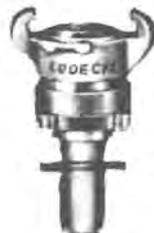
Mody-Schraubkupplung aus Temperguß verzinkt mit Gummidichtung und Sicherheitsdoppelnocken, PN 16 SLW 19 mm, Gewicht 0,35 kg, Magazin-Sach-Nr.: 5018565.
