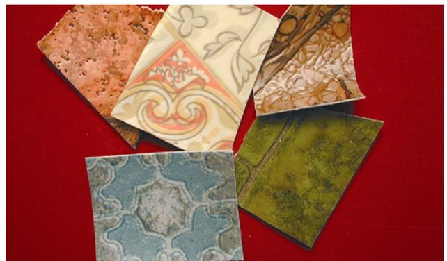
2 Mehrschichtige Bodenbeläge (Cushion-Vinyl) bestehen in der Regel aus PVC mit einer Trägerschicht aus schwachgebundenem Asbest.
