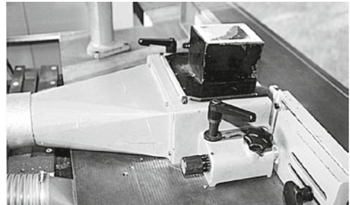
3 Verdeckung (Schutzkasten) zur Sicherung des Werkzeugs hinter dem Kehlanschlag und zum Auffangen von Staub und Spänen. Der obere Teil kann aufgeklappt werden, so dass ein Werkzeugwechsel ohne Demontage des Schutzkastens erfolgen kann.
