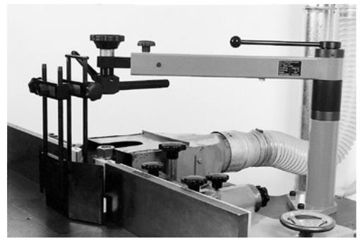
5 Schutz- und Druckvorrichtung der Suva für das Kehlen am Anschlag.
