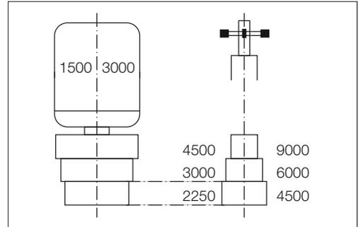
2 Beispiel eines Drehzahlschaubildes, wie es in der Nähe des Riemenantriebes angebracht sein muss.
