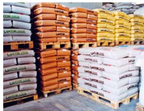
5 Stockage de sacs avec palette intermédiaire. Pour conserver la qualité du produit, la hauteur d'empilage a été limitée à deux palettes.
