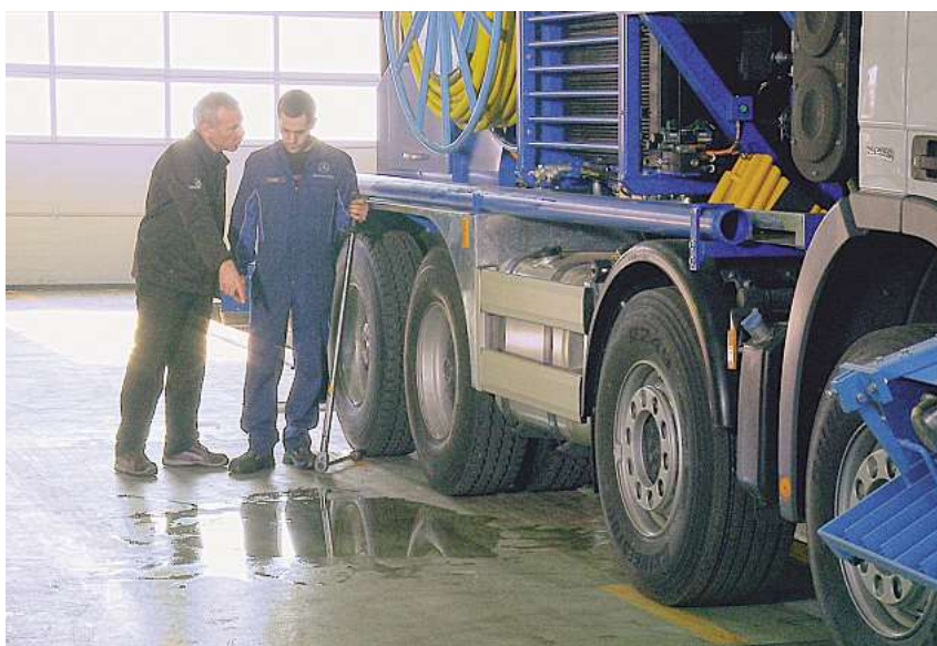
Per evitare le cadute in piano: in caso di sversamento di oli o altri liquidi usare subito un legante per oli e rimuovere il tutto.
