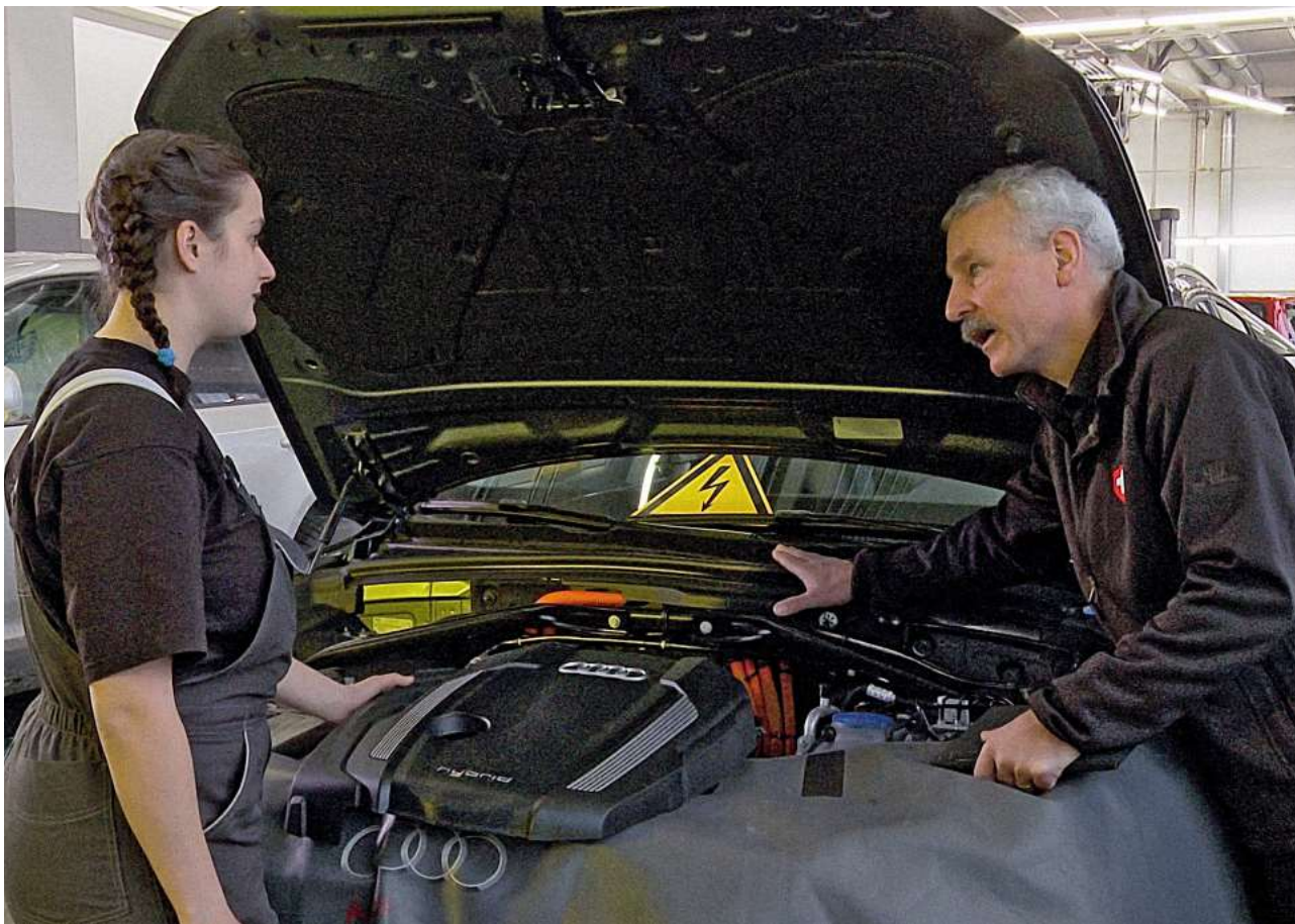
Figura 3: le auto ibride presentano delle parti in alta tensione e si può intervenire per la riparazione solo dopo aver tolto la tensione al veicolo.
