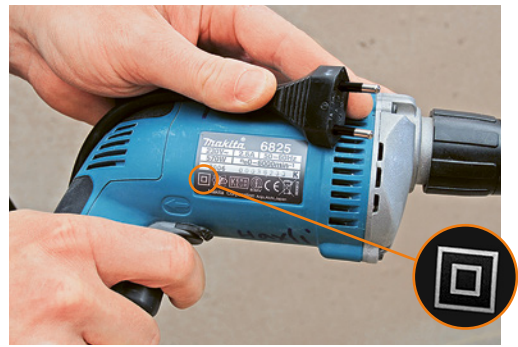
1 Bohrmaschine der Schutzklasse II mit entsprechender Kennzeichnung.
