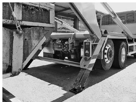
8 Lors d'un déchargement par basculement, des forces importantes s'exercent sur le véhicule: il faut sortir les stabilisateurs.
