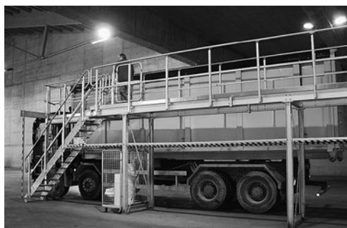
6 Plateforme de travail utilisée pour la mise en place et l'enlèvement des bâches et des filets
