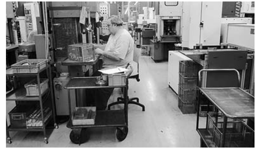
Bild 1: Für ausreichend Bewegungsfreiheit ist ein Raum von mindestens 800 mm erforderlich.
