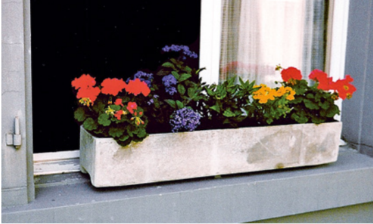
Blumenkisten aus Asbestzement
