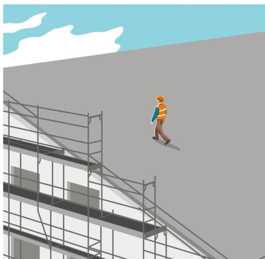
**Regola 2:** a partire da un'altezza di 2 m mettiamo in sicurezza le zone con rischio di caduta a bordo tetto.
