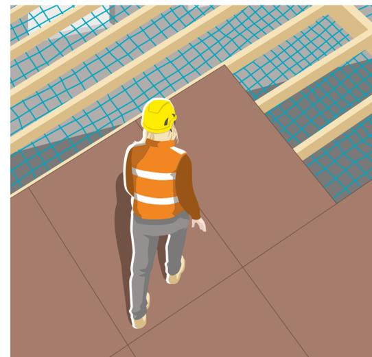
**Regola 3:** da un'altezza di 2 m adottiamo misure di sicurezza per evitare le cadute verso l'interno.
