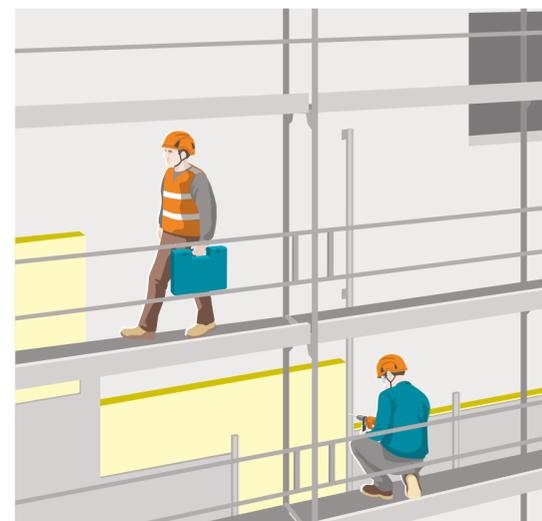
**Regola 6:** per i lavori sulle facciate utilizziamo un ponteggio sicuro o una piattaforma di lavoro elevabile.
