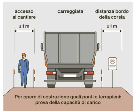
7 La separazione delle vie di passaggio e del traffico di cantiere crea carreggiate sicure.
