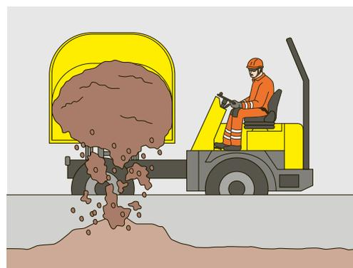
6 Punto di scarico con elemento di protezione, che deve essere pari ad almeno  $\frac{1}{3}$  dell'altezza delle ruote per evitare che si superi il bordo della scarpata.
