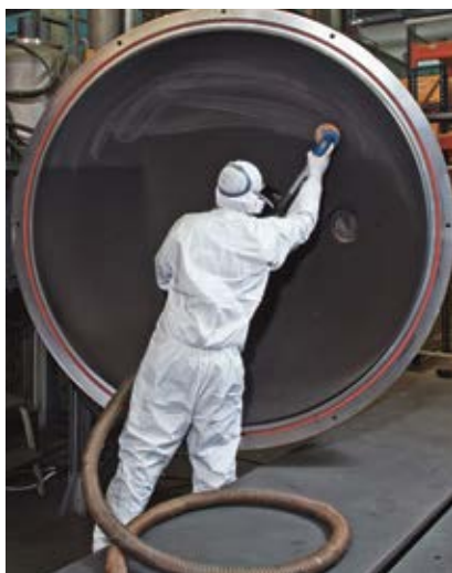
Fig. 5: ne nettoyer les cabines de projection qu'avec des aspirateurs industriels agréés et en portant les EPI appropriés.
