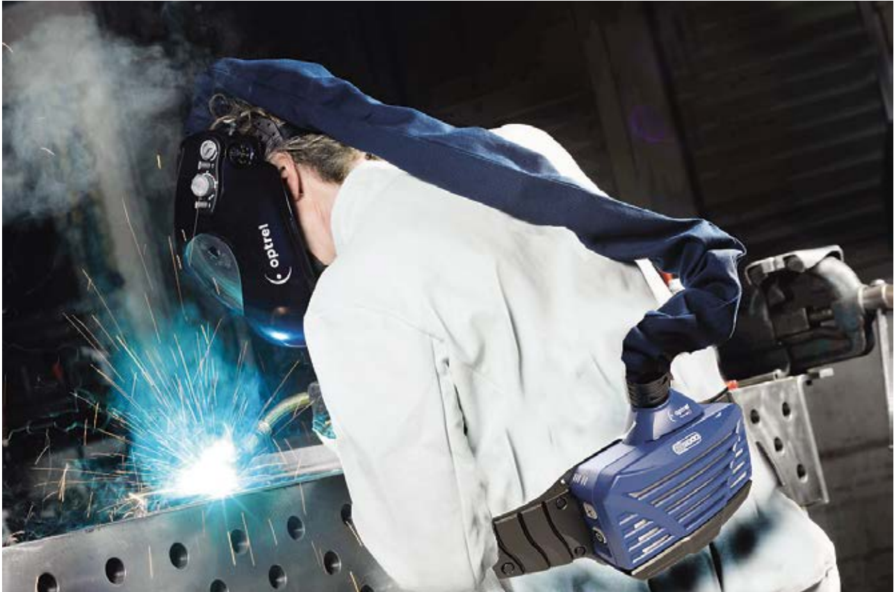
Fig. 3: protection respiratoire lors de soudage MIG/MAG: appareil filtrant à ventilation assistée avec casque de soudeur et filtre à particules réutilisable de la classe TH3P R SL.
