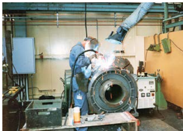
Fig. 1: le soudage MIG/MAG d'acier allié produit des fumées et de la poussière contenant du nickel.
