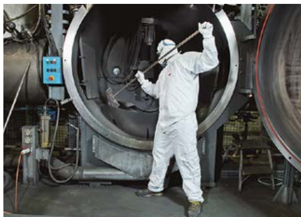
Fig. 4: les poussières de projection représentent une mise en danger importante lors du nettoyage de cabines de projection.
