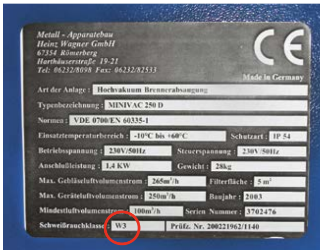
Figure 2: plaque signalétique d'un système d'aspiration intégré à la torche de soudage avec la classe de séparation des fumées de soudage W3.
